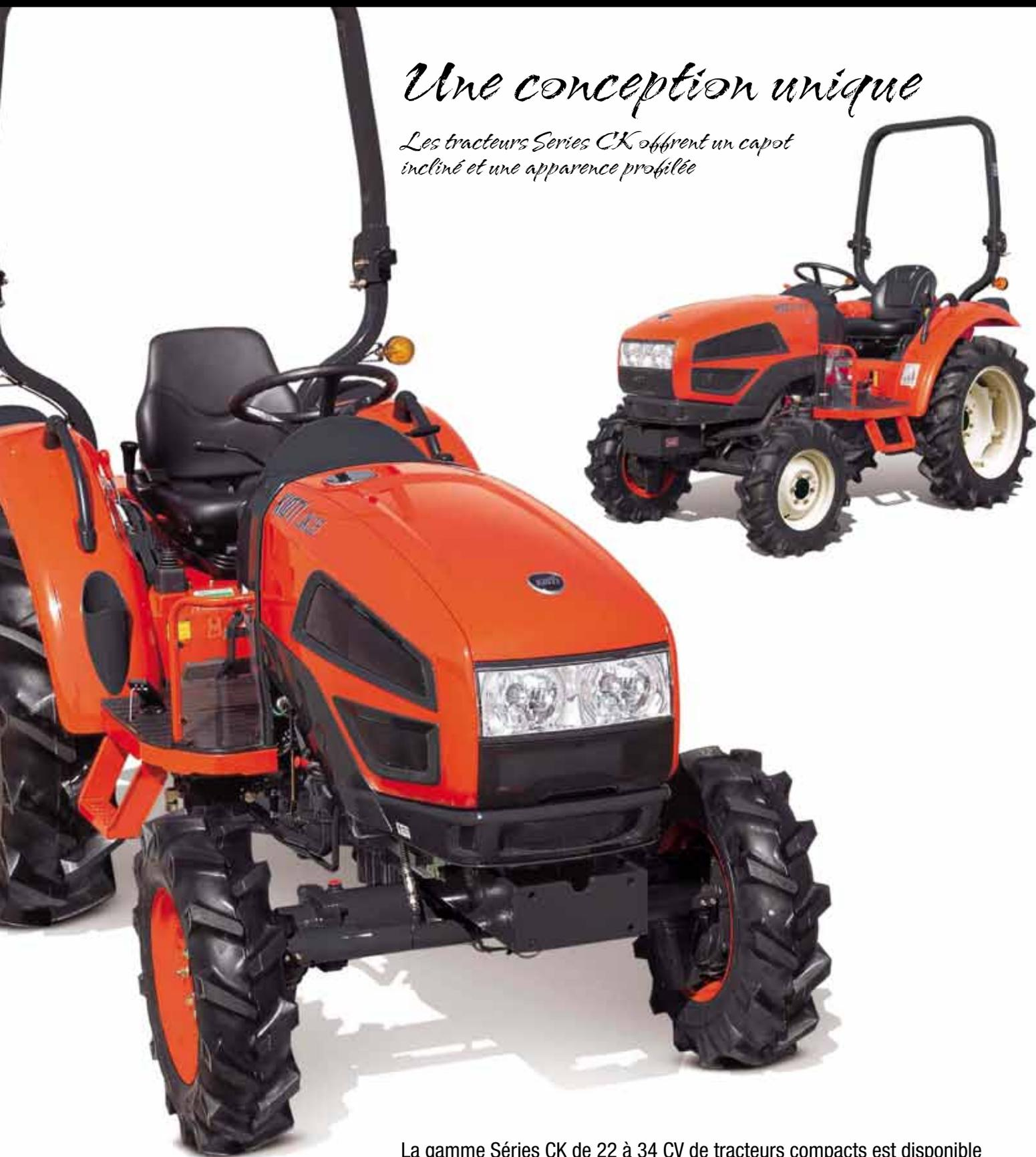
La gamme Séries CK de 22 à 34 CV de tracteurs compacts est disponible avec transmission hydrostatique ou manuelle. Les tracteurs sont équipés de différentes fonctions et sont ultra silencieux, à faibles vibrations, et leur moteur diesel Daedong respecte l'environnement. Tous les tracteurs de Série CK sont équipés d'une pédale d'embrayage et de frein suspendus, permettant au conducteur de conduire plus confortablement.
